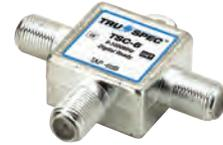
**Acoplador direccional de 1 GHz con dos derivaciones (Tap).** Tiene un rango de operación de 5 a 1000 MHz, para uso en interiores y exteriores, es de caja soldada y tienen blindaje contra interferencia electromagnética (EMI) > -130 dB.
