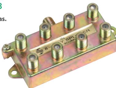
Divisores (Splitter), de 75 Ohms para señal de televisión, cable o satélite, de 1 GHz, escudo de 90 dB para RFI (Interferencia de Radio Frecuencia) caja de aleación de zinc sellada con resina epóxica, acabado en cromo anticorrosivo.
