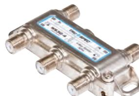
**Acopladores direccionales tipo "T" de 1 GHz, con derivación (TAP).** Tiene un rango de operación de 5 a 1000 MHz, es para uso en exteriores, diseñado para montaje en pared, es de caja soldada y tienen blindaje contra interferencia electromagnética (EMI) >-130 dB. Y tienen una pérdida por inserción de -2 dB promedio.
