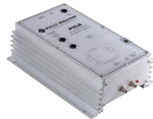
**Amplificadores de distribución de 15 dB de ganancia, con canal de retorno, es de bajo ruido.** Tiene un rango de frecuencia de 5 a 1000 MHz, fuente de alimentación externa de 12 Volts y está diseñado para distribución de señales de CATV y VHF/UHF. Disponible en las siguientes versiones con salidas múltiples que simplifica el uso de divisores:
