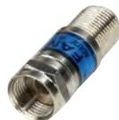
**Atenuador en línea fijo tipo mini, con paso de energía,** ancho de banda de 5 MHz a 1 GHz, pérdida por retorno de 25 dB, cuerpo de latón sólido recubierto de níquel, tarjeta de circuito impreso en cerámica monolítica que asegura una construcción robusta y resistor grabado tipo vidriado que provee una exactitud de  $\pm 5\%$ .
