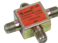
**Divisores (splitter) de alto rendimiento, con paso de voltaje por todos los puertos, de 1 GHz a 75 Ohms, para señal de televisión o cable.** Tienen caja soldada de aleación de zinc terminada en cromo anticorrosivo, que proporciona un escudo contra interferencia electromagnética de 130 dB (EMI), pérdida por inserción de 3,6 a 4,2 dB y aislamiento de puertos de 25 a 28 dB.
