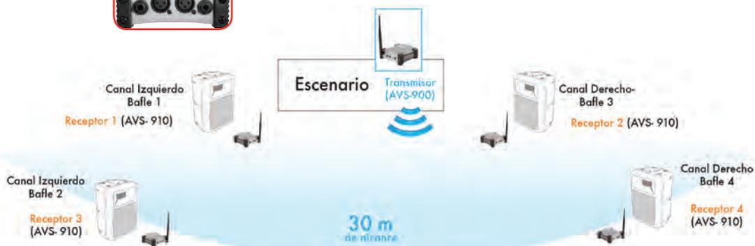
audio bafile, sistema portátil, transmisor y receptor
